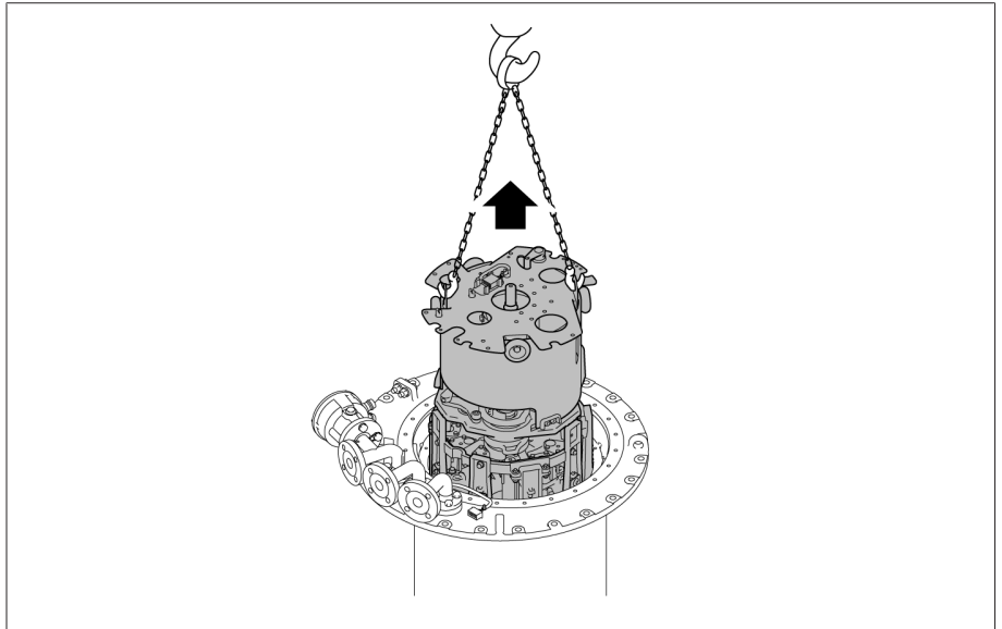
Figura 58: Suspender o corpo insertável da chave de carga
